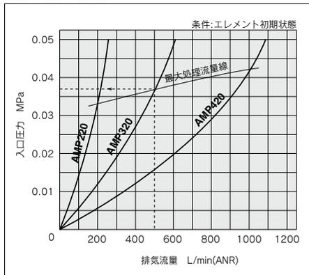
図の見方: AMP320を流量500L/minで使用した場合、入口圧力は0.037MPaとなります。
